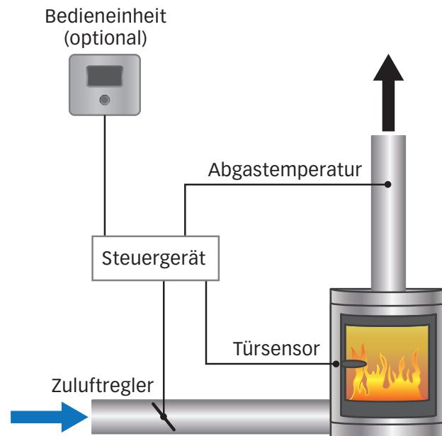
Die OSG überwacht kontinuierlich die Temperatur des Abgases und ermittelt den optimalen Zeitpunkt für die Drosselung der Luftzufuhr. So bleibt die Wärme im Ofen erhalten. Wird eine Türöffnung z.B. bei
